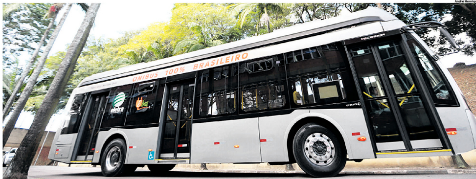
MAIS ECONÔMICO. Ônibus fabricados pela Eletra são 100% elétricos e têm autonomia para circular por até 240 quilômetros sem precisar recarregar a bateria
