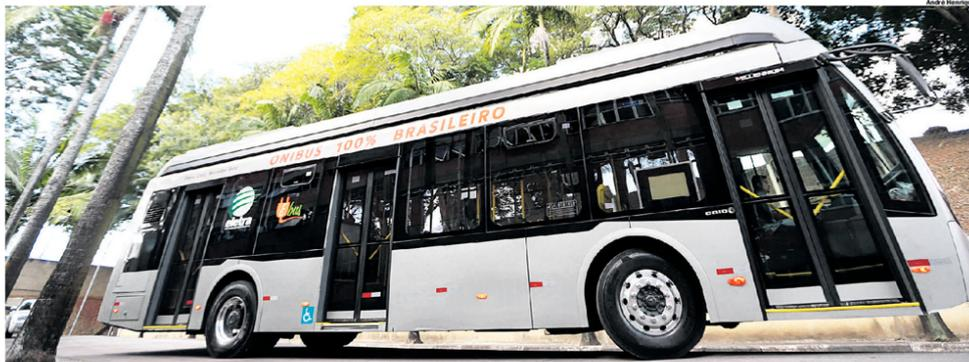
**MAIS ECONÔMICO.** Ônibus fabricados pela Eletra são 100% elétricos e têm autonomia para circular por até 240 quilômetros sem precisar recarregar a bateria
