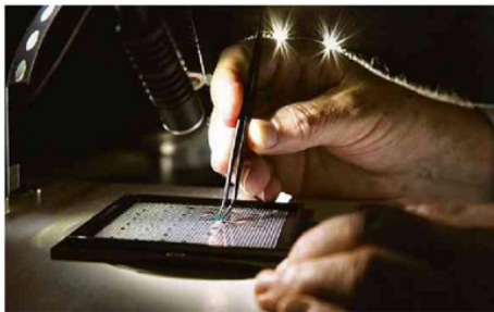
Peter (acima), do Instituto de Semicondutores da Unisinos, segura um wafer, lâmina de silício. Abaixo, detalhe de um chip não encapsulado
