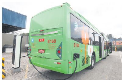
CARGA TOTAL. Ônibus elétrico do BRT durante carregamento de bateria: carga completa leva 3h
