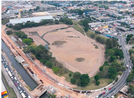
PRECAUÇÃO. Limpeza dos reservatórios, como o da Paulicéia, em São Bernardo, tende a minimizar impacto das chuvas de verão
