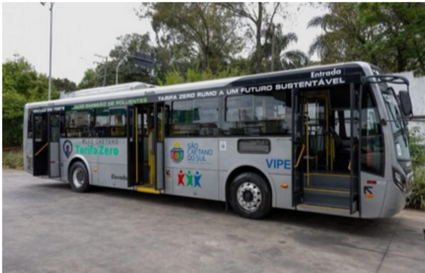
O ônibus da BYD (modelo D9A) é de alta capacidade de passageiros, com média de 250 km de autonomia de bateria.
