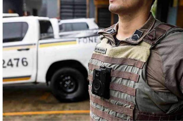
Gravação começa automaticamente, assim que o aparelho é retirado da "doca", a base de carregamento
