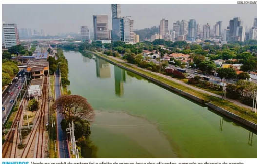
PINHEIROS. Verde na manhã de ontem foi o efeito de menos água dos afluentes, somado ao despejo de esgoto, que alimentou micro-organismos e provocou a mudança de cor do leito do rio que corta parte da capital paulista
