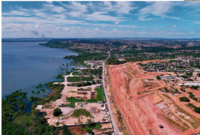
Ritmo de 2,6 centímetros por hora. Vista aérea de chão que cede no Mutange, em Maceió; minas de sal-gema da Braskem afetaram outros quatro bairros
