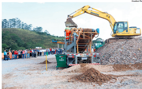
USINA MÓVEL. Equipamento tem capacidade para triturar de 80 a 100 toneladas de resíduos por hora
