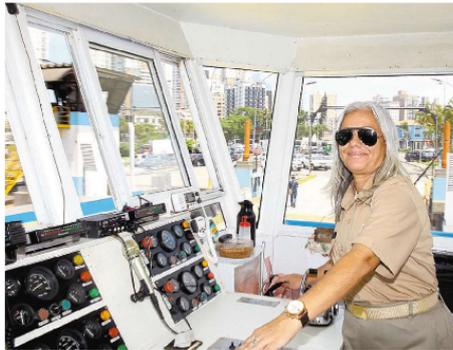
■ A reforma da balsa *FB-26* incluiu a revisão de quatro motores, a implantação de novo sistema de comando, linha de eixo e máquina do leme, e a substituição de chapas metálicas da estrutura. Os equipamentos de salvatagem, disponíveis aos usuários para emergências, também foram trocados. Foi feita, ainda, a pintura do casco, que passou por tratamento especial para navegação no mar, e houve melhorias nos porões, no convés e na praça de máquinas.
