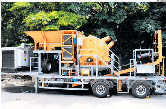
CAPACIDADE. Equipamento montado em caminhão pode triturar de 80 a 100 toneladas por hora
